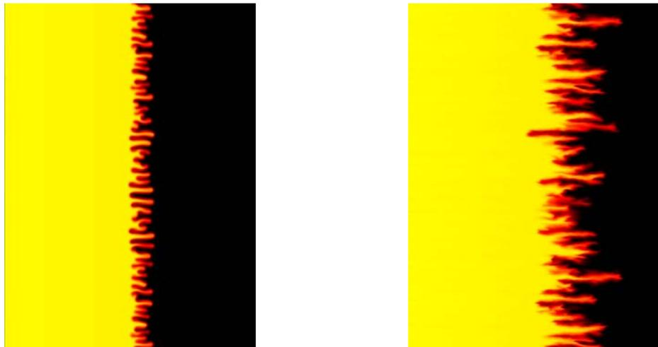
Figure 2 : Simulation numérique par technique BGK sur réseau du déplacement d'un fluide visqueux par un fluide moins visqueux, dans un poreux bidimensionnel. La figure de gauche correspond à un poreux homogène, la figure de droite, à un poreux hétérogène de même perméabilité moyenne.
